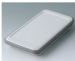
B5403317 SLIM-CASE M, исп. VI ACA+ПК (UL 94 V-0) белый RAL 9002 148x74x22mm IP 54
