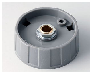
A2540068 Круглая ручка 40, без риски АБС (UL 94 HB) пыльно-серый RAL 7037 40x15mm 6mm
