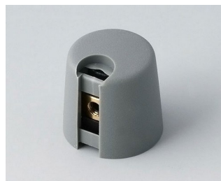
A1016068 Ручка TOP-KNOB 16 ПА 6 вулкан 16x16mm 6mm
