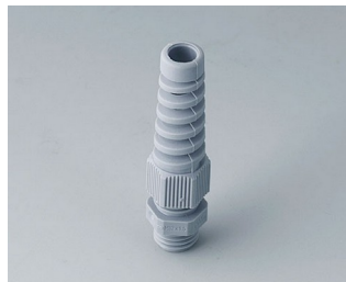
C2312518 Кабельный ввод M12 x 1,5, с защитой от изгиба ПА 6 серебристо-серый RAL 7001 IP 68
