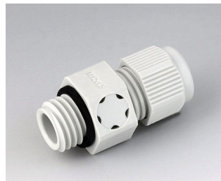
C2312917 Кабельный ввод M12x1,5, с компенсацией давления ПА 6 (UL 94 V-0) светло-серый RAL 7035 IP 68
