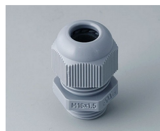
C2316418 Кабельный ввод M16 x 1,5 ПА 6 серебристо-серый RAL 7001 IP 68
