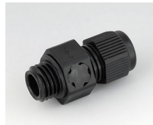
C2312919 Кабельный ввод M12x1,5, с компенсацией давления ПА 6 (UL 94 V-0) черный RAL 9005 IP 68
