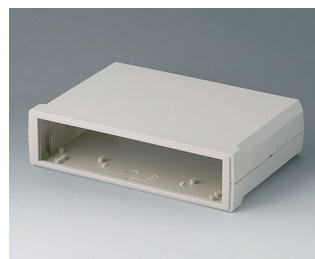
V3023117 MOTEC L, низкий АБС (UL 94 HB) белый RAL 9002 235x165x60mm IP 40
