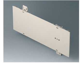
A0121280 Боковая панель 2 U с отверстиями для крепления ручки АБС (UL 94 HB) тепло-серый RAL 7032 250x88,9mm
