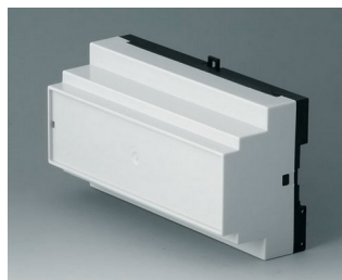
B6505113 RAILTEC B, 9 модулей, исп. III ПК (UL 94 V-0) светло-серый RAL 7035 157x86x59mm
