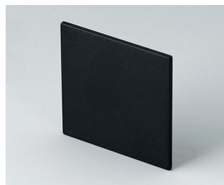
B6112221 Лицевая панель PPO (UL 94 V-0) черный RAL 9005 43,7x43,7x2mm
