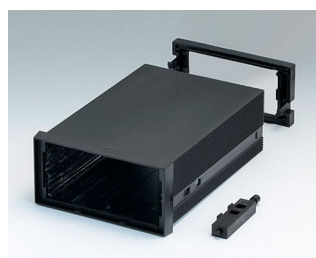
B6032072 DIN-MODULAR CASE тип А, исп. II PPO (UL 94 V-0) черный RAL 9005 96x48x131mm
