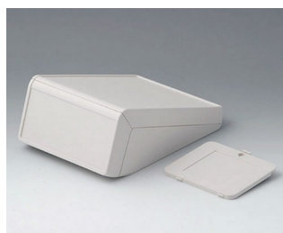
B4056317 UNITEC M, 1,4/1,4 АБС (UL 94 HB) белый RAL 9002 148x210x80mm IP 40
