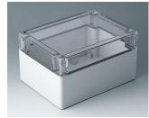
С7016064 IN-BOX AБС/ПК (UL 94 HB) светло-серый RAL 7035 162x122x90mm IP 66, IP 67, IK 07
