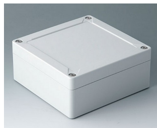
C7013031 IN-BOX АБС (UL 94 HB) светло-серый RAL 7035 124x122x55mm IP 66, IP 67, IK 07
