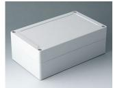
С7020042 IN-BOX ПК светло-серый RAL 7035 202x122x75mm IP 66, IP 67, IK 08
