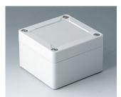
C7008011 IN-BOX AБС (UL 94 HB) светло-серый RAL 7035 84x82x55mm IP 66, IP 67, IK 07
