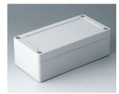
C7016011 IN-BOX AБС (UL 94 HB) светло-серый RAL 7035 162x82x55mm IP 66, IP 67, IK 07
