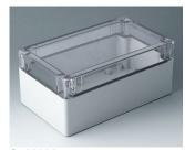
С7020064 IN-BOX АБС/ПК (UL 94 HB) светло-серый RAL 7035 202x122x90mm IP 66, IP 67, IK 07
