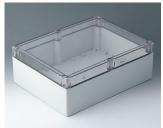
С7030114 IN-BOX АБС/ПК (UL 94 HB) светло-серый RAL 7035 302x232x110mm IP 66, IP 67, IK 07
