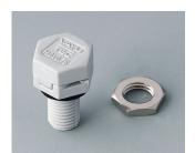
С2306917 Клапан компенсации давления, M6 x 0,75 ПА 6 (UL 94 HB) светло-серый RAL 7035 IP 56
