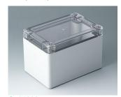
С7012024 IN-BOX АБС/ПК (UL 94 HB) светло-серый RAL 7035 122x82x85mm IP 66, IP 67, IK 07
