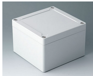
C7013051 IN-BOX АБС (UL 94 HB) светло-серый RAL 7035 124x122x85mm IP 66, IP 67, IK 07
