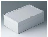
C7025081 IN-BOX AБС (UL 94 HB) светло-серый RAL 7035 252x162x90mm IP 66, IP 67, IK 07
