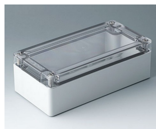
C7016014 IN-BOX АБС/ПК (UL 94 HB) светло-серый RAL 7035 162x82x55mm IP 66, IP 67, IK 07
