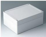
С7021072 IN-BOX ПК светло-серый RAL 7035 202x152x90mm IP 66, IP 67, IK 08
