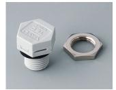
С2310917 Клапан компенсации давления, М10 x 1 ПА 6 (UL 94 HB) светло-серый RAL 7035 IP 56
