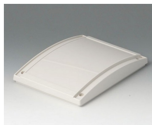
B4013637 Крышка S, округлая АБС (UL 94 HB) белый RAL 9002 130x180x28mm
