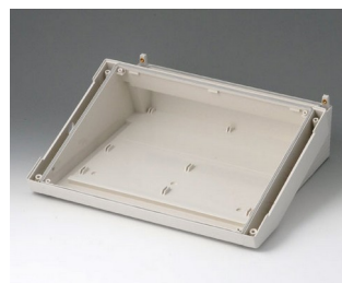
B4030317 DATEC-TERMINAL L, исп. III АБС (UL 94 HB) белый RAL 9002 302x272x101mm IP 54 opt.
