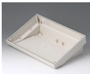
B4026117 DATEC-TERMINAL SL АБС (UL 94 HB) белый RAL 9002 264x180x86mm IP 54 opt.
