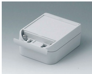
C6009121 SMART-BOX (ширина 90) АСА+ПК (UL 94 V-0) светло-серый RAL 7035 120x90x50mm IP 66
