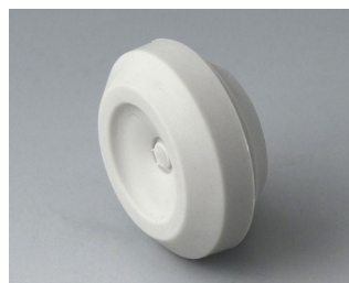
C2316147 Кабельная манжета ТПЭ светло-серый RAL 7035 IP 67
