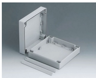
C2016161 ROBUST-BOX с шириной 160, исп. I АБС (UL 94 HB) светло-серый RAL 7035 160x160x60mm IP 66
