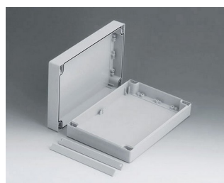
C2016241 ROBUST-BOX с шириной 160, исп. I АБС (UL 94 HB) светло-серый RAL 7035 240x160x60mm IP 66
