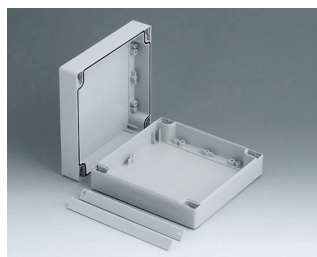
C2016162 ROBUST-BOX с шириной 160, исп. II ПК (UL 94 HB) светло-серый RAL 7035 160x160x60mm IP 66
