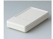
A9070117 DATEC-POCKET-BOX S AБС (UL 94 HB) белый RAL 9002 85x46x16mm IP 54
