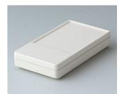
A9070107 DATEC-POCKET-BOX S AБС (UL 94 HB) белый RAL 9002 85x46x16mm IP 41
