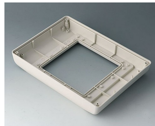
B4044757 Нижняя часть М высокая в исп. I АБС (UL 94 HB) белый RAL 9002 225x165x35,5mm IP 54 opt.
