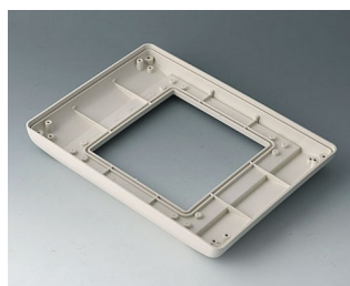
B4044717 Нижняя часть M низкая в исп. II АБС (UL 94 HB) белый RAL 9002 225x165x25,5mm IP 54 opt.
