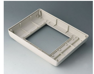
B4044757 Нижняя часть М высокая в исп. I АБС (UL 94 HB) белый RAL 9002 225x165x35,5mm IP 54 opt.
