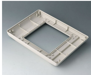
B4044707 Нижняя часть М низкая в исп. I АБС (UL 94 HB) белый RAL 9002 225x165x25,5mm IP 54 opt.
