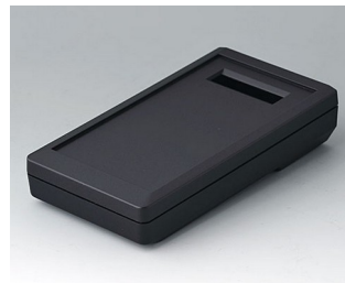
A9073319 DATEC-MOBIL-BOX S, исп. III АБС (UL 94 HB) черный RAL 9005 152x83x33,5mm IP 65 opt.
