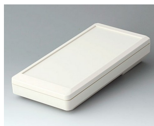
A9075117 DATEC-MOBIL-BOX L, исп. I АБС (UL 94 HB) белый RAL 9002 252x121x50mm IP 65 opt.
