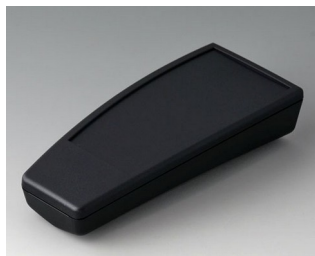
A9067219 SMART-CASE L, исп. II ПММА (ИК) (UL 94 HB) черный RAL 9005 140x62,7x30,5mm IP 65 opt., IP 40
