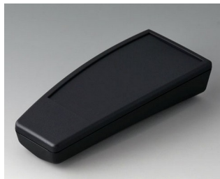
A9067119 SMART-CASE L, исп. II АБС (UL 94 HB) черный RAL 9005 140x62,7x30,5mm IP 65 opt., IP 40
