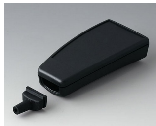
A9066339 SMART-CASE M, исп. IV АБС (UL 94 HB) черный RAL 9005 96x47x24mm IP 40
