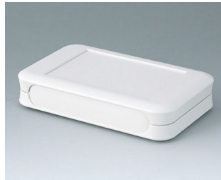
A9052107 SOFT-CASE L АБС (UL 94 HB) белый RAL 9002 73x117x24mm IP 54 opt., IP 40
