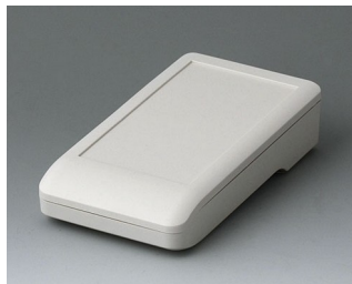
A9005107 DATEC-COMPACT S АСА+ПК (UL 94 V-0) белый RAL 9002 136x74x32mm IP 65
