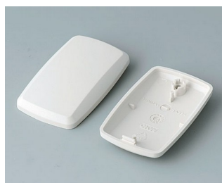
B9002857 Верхняя и нижняя части ES АБС (UL 94 HB) белый RAL 9002 52x32x15mm
