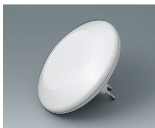
B5011027 ART-CASE R110 F (с вилкой) ПК+АБС (UL 94 V-0) белый RAL 9002 ø110x30mm IP 40
