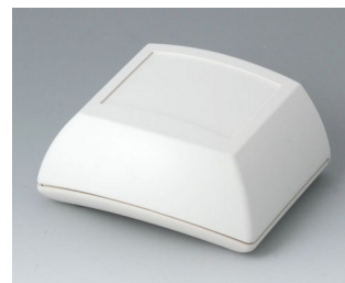
B7005107 ERGO-CASE S, высокий АБС (UL 94 HB) белый RAL 9002 80x96x44mm IP 54 opt.
