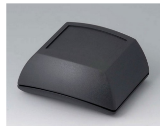
B7005109 ERGO-CASE S, высокий АБС (UL 94 HB) черный RAL 9005 80x96x44mm IP 54 opt.
