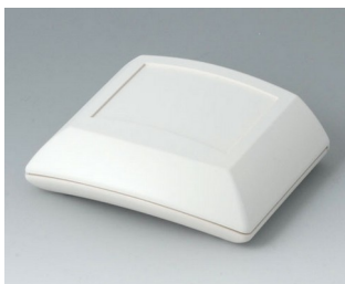
B7000107 ERGO-CASE S, плоский АБС (UL 94 HB) белый RAL 9002 80x96x32mm IP 54 opt.
