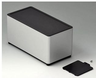
EE209059 SYNERGY E200 Алюминий AlMgSi 0,5 матово-анодированный 200x100x100mm IP 40
