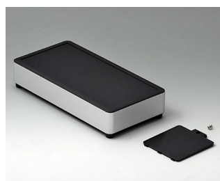
EE203059 SYNERGY E200 Алюминий AlMgSi 0,5 матово-анодированный 200x100x40mm IP 40
