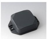
B1804228 MINI-DATA-BOX SF50, высокий, с ушками ACA+ПК (UL 94 V-0) тёмно-серый RAL 7016 50x50x20mm IP 65 opt., IP 40
