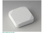
B1804117 MINI-DATA-BOX S50, плоский ACA+ПК (UL 94 V-0) белый RAL 9016 50x50x15mm IP 65 opt., IP 40
