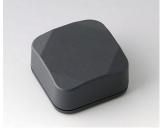
B1802218 MINI-DATA-BOX S40, высокий ACA+ПК (UL 94 V-0) тёмно-серый RAL 7016 40x40x20mm IP 65 opt., IP 40
