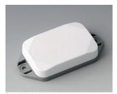
B1822126 MINI-DATA-BOX EF40, плоский, с ушками ACA+ПК (UL 94 V-0) белый RAL 9016 60x40x15mm IP 65 opt., IP 40
