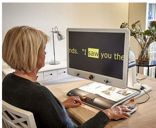
Boutons de commande pour téléagrandisseur
