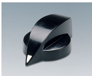
A1321860 BOUTON, à fixation latérale par vis PF noir RAL 9005 23x16mm 6mm
