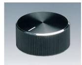
A1422260 BOUTON, à fixation latérale par vis ABS (UL 94 HB) noir/alu 22,8x13mm 6mm
