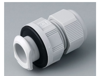
C2320717 Passe-câble à vis, M20, quick fix PA 6 gris clair RAL 7035
