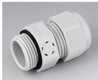
C2320917 Passe-câble à vis M20x1,5, compensation de pression PA 6 (UL 94 V-0) gris clair RAL 7035 IP 68
