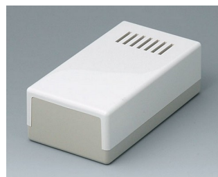
A9020265 BOITIER PLAT 120 S ABS (UL 94 HB) gris blanc RAL 9002 120x65x40mm
