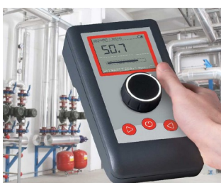
Trouvez les fuites d'air comprimé à l'aide d'ultrasons
