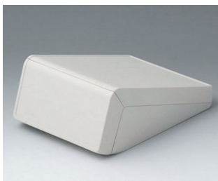
B4056107 UNITEC M, 0,6/0,6 ABS (UL 94 HB) gris blanc RAL 9002 148x210x80mm IP 40
