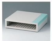
B2210015 MEDITEC D 220, sans poignée étrier ABS (UL 94 HB) gris blanc RAL 9002 290x260x74mm IP 40
