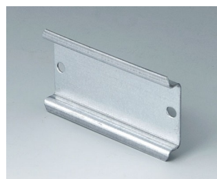
C7110077 Barrette normalisée, type TH 35 Acier 66x35x7,5mm
