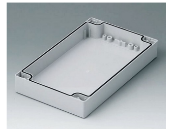
C1122002 Coquille 120, avec joint PC (UL 94 HB) gris clair RAL 7035 200x120x30mm
