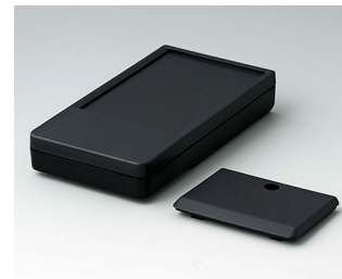
A9072219 DATEC-POCKET-BOX L PMMA (IR) (UL 94 HB) noir RAL 9005 120x65x22mm IP 54
