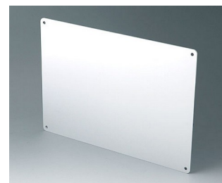
B4146106 Plaque avant L Aluminium anodisé mat 271,5x191,5x2mm
