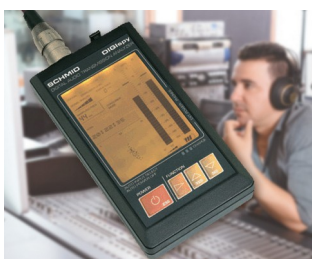
Appareil d'analyse portable pour interfaces audio-numériques
