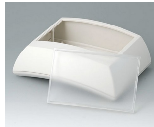
B7025247 ERGO-CASE L, surélévée ABS (UL 94 HB) gris blanc RAL 9002 150x200x69mm IP 40
