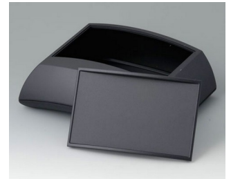
B7025139 ERGO-CASE L, surélévée ABS (UL 94 HB) noir RAL 9005 150x200x69mm IP 40
