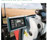
Terminal ISOBUS pour tracteurs et machines automotrices
