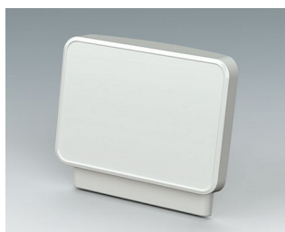
C3602407 Face avant S ASA+PC (UL 94 V-0) blanc signalisation RAL 9016 284x68x244mm
