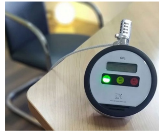
Feu de signalisation CO2
