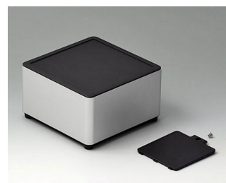
ES126059 SYNERGY S120 Aluminium AIMgSi 0,5 anodisé mat 120x120x70mm IP 40
