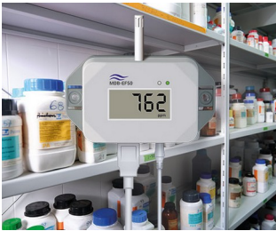
Détecteur de gaz pour substances dangereuses
