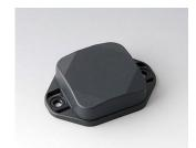
B1802128 MINI-DATA-BOX SF40, plate avec bride ASA+PC (UL 94 V-0) gris anthracite RAL 7016 40x40x15mm IP 65 opt., IP 40
