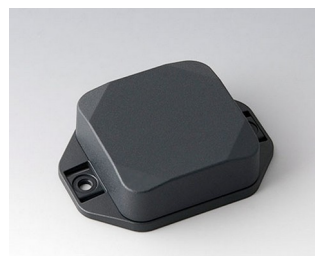
B1804228 MINI-DATA-BOX SF50, haute avec bride ASA+PC (UL 94 V-0) gris anthracite RAL 7016 50x50x20mm IP 65 opt., IP 40
