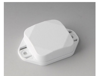
B1802127 MINI-DATA-BOX SF40, plate avec bride ASA+PC (UL 94 V-0) blanc signalisation RAL 9016 40x40x15mm IP 65 opt., IP 40
