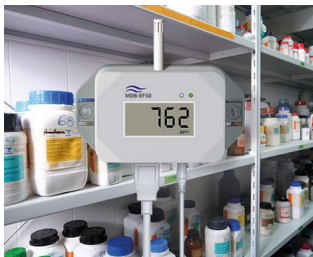
Détecteur de gaz pour substances dangereuses
