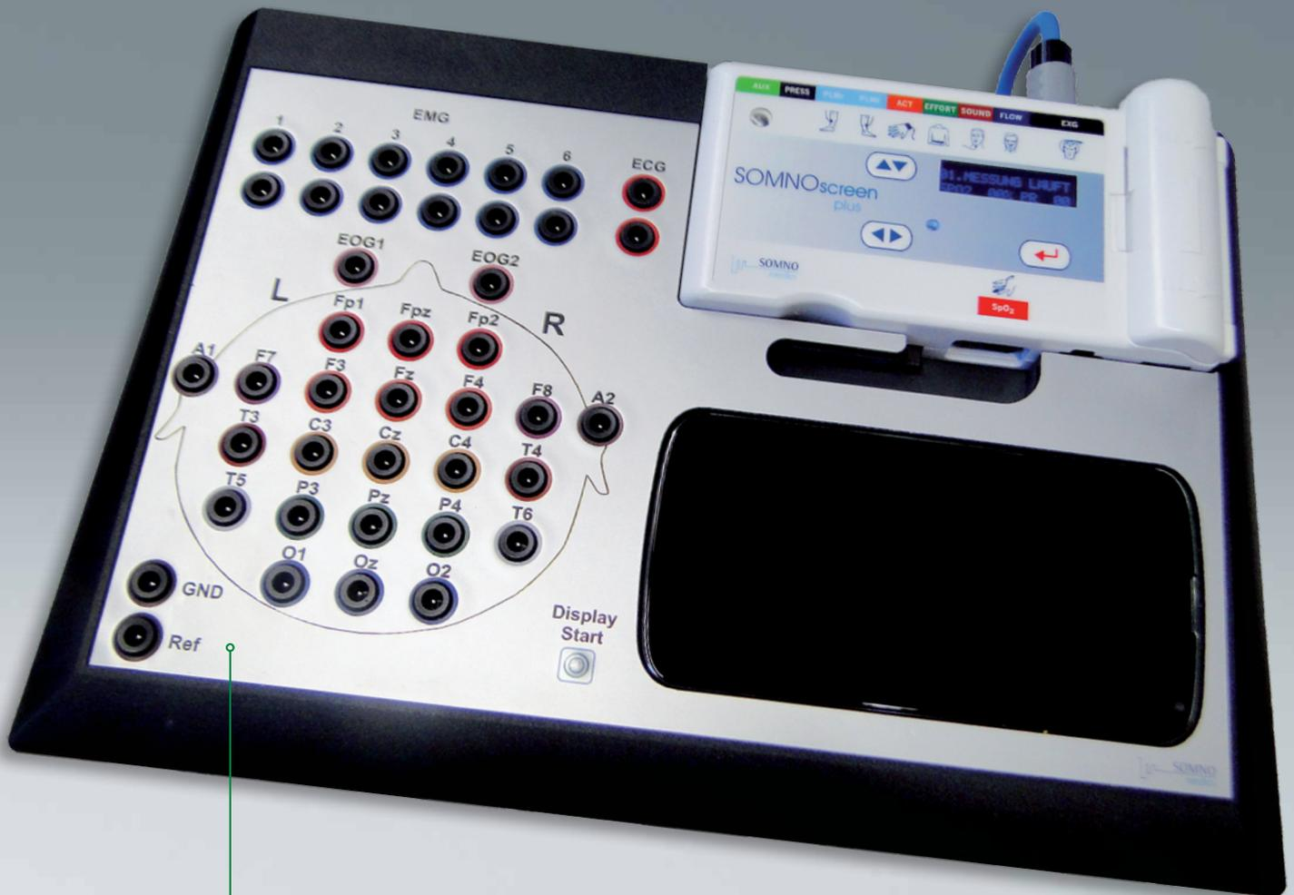
**Übersichtliche Steckplätze** ermöglichen dem Anwender, die EEG Elektroden während einer stationären Routineuntersuchung zeitsparend einzustecken.
