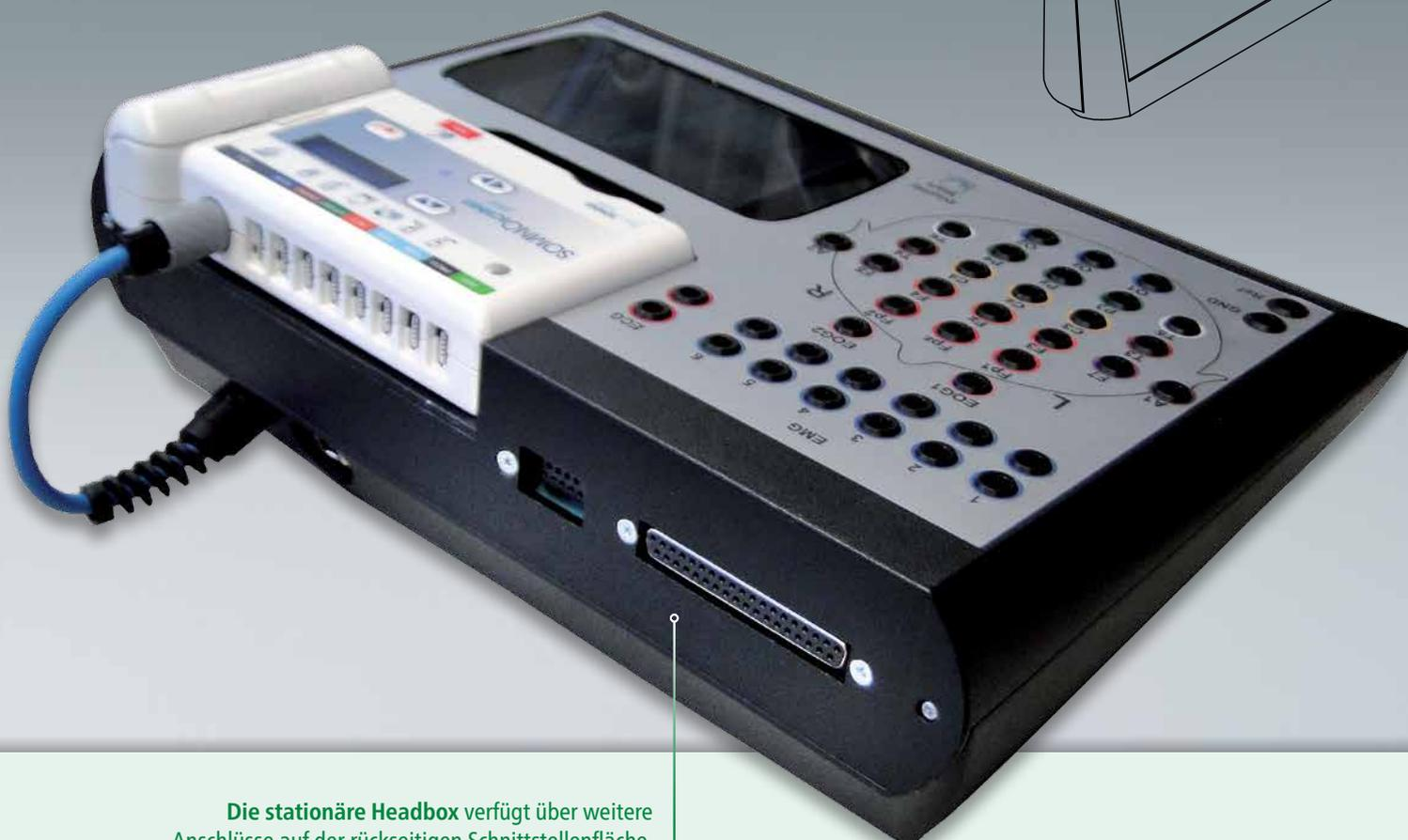
Die stationäre Headbox verfügt über weitere Anschlüsse auf der rückseitigen Schnittstellenfläche.
