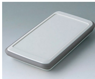
B5403317 SLIM-CASE M, Ausf. VI ASA+PC (UL 94 V-0) grauweiß RAL 9002 148x74x22mm IP 54
