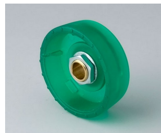
B8333065 STAR-KNOBS 33, mit Noppen PC (UL 94 HB) smaragd 33x14mm 6mm
