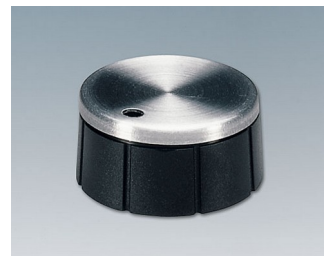
A1624260 DREHKNOPF, mit seidl. Schraubbefestigung ABS (UL 94 HB) schwarz/Alu 24x12,4mm 6mm
