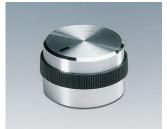
A1421469 DREHKNOPF, mit seitl. Schraubbefestigung ABS (UL 94 HB) glänzend 22,1x14,3mm 6mm
