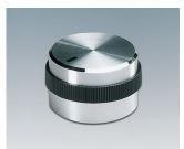
A1422469 DREHKNOPF, mit seitl. Schraubbefestigung ABS (UL 94 HB) glänzend 22,2x17,9mm 6mm
