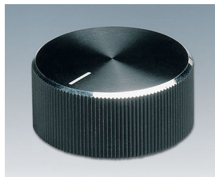
A1432260 DREHKNOPF, mit seittl. Schraubbefestigung ABS (UL 94 HB) schwarz/Alu 33x14,3mm 6mm
