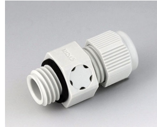
C2312917 Kabelverschraubung M12x1,5, mit Integriertem Druckausgleich PA 6 (UL 94 V-0) lichtgrau RAL 7035 IP 68
