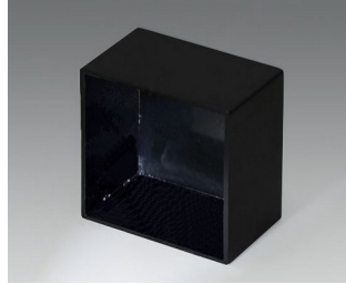
A8032208 MODUL-LEERGEHÄUSE, Ausf. III PA 66 (UL 94 V-2) schwarz RAL 9005 32,4x32,4x20mm
