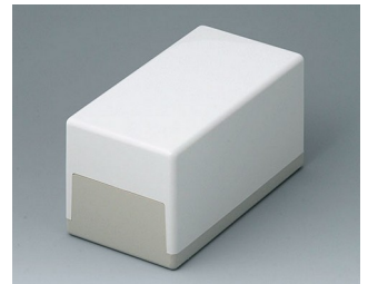
A9031065 FLACHGEHÄUSE 150 H, Ausf. I ABS (UL 94 HB) grauweiß RAL 9002 150x80x80mm IP 40
