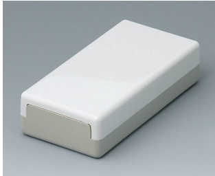
A9010065 FLACHGEHÄUSE 100 N, Ausf. I ABS (UL 94 HB) grauweiß RAL 9002 100x50x25mm IP 40
