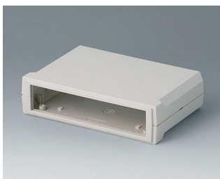
B3015117 MOTEC S, flach/flach ABS (UL 94 HB) grauweiß RAL 9002 155x105x40mm IP 40
