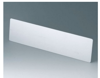
A0326370 Front-/ Rückplatte 63 TE 2 HE Aluminium matt eloxiert 357,8x90,7x2mm
