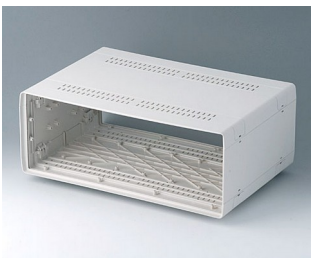
A0236270 EUROPA-GEHÄUSE 63 TE, o. Griffb. ABS (UL 94 HB) grauweiß RAL 9002 367x250x143mm
