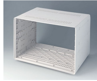
A0266270 EUROPA-GEHÄUSE 63 TE, o. Griffb. ABS (UL 94 HB) grauweiß RAL 9002 367x250x276,5mm
